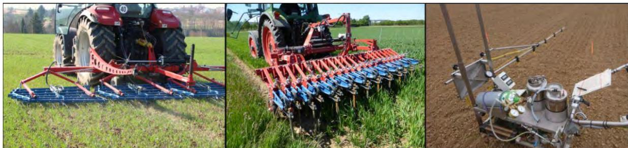
**Слева направо: сенсорная борона на поле озимой пшеницы 2020/2021; мотыга с видеокамерой и опрыскиватель, использовавшиеся на поле озимой пшеницы 2020/2021 в Энингене. Авторы фото: Маркус Сайле, Майкл Спэт, Роланд Герхардс.**
